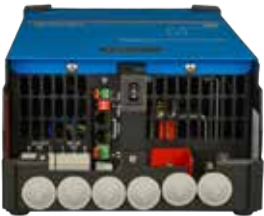
MultiPlus 2000 VA (alt kapak çıkarılmış)
