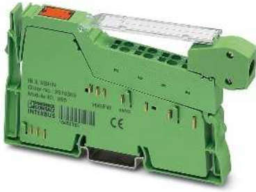
SSI arabirimli ölçüm sistemleri veya mutlak rotasyon için giriş
