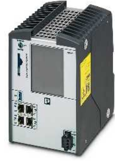
Entegre safety kontrolörlü 400 sınıfı kompakt kontrolör
