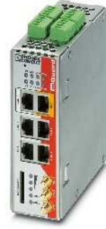
Güvenlik duvarı ve VPN'li, yönetilebilir 4-portlu anahtar, DMZ port ve 2. WAN arayüzü
