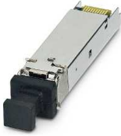
Cam fiber, 80 km'ye varan Gigabit iletim mesafesi için
