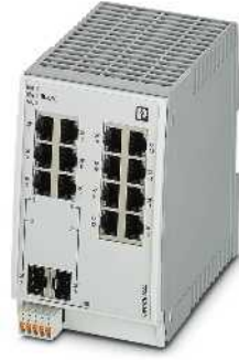
14 RJ45 bağlantı noktası ve 2 SFP bağlantı noktası 10/100 Mbps
