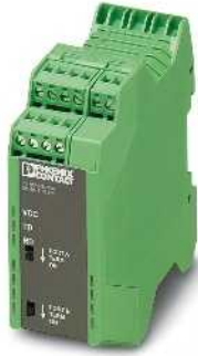
RS-485 2-telli sistemler için tekrarlayıcı, 4-yollu izolasyon, modüler genişlemeyi destekler
