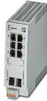
6 RJ45 bağlantı noktası ve 2 SFP bağlantı noktası 10/100/1000 Mbps
