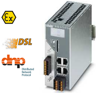
Yönetilebilir Ethernet genişletici, 2 SHDSL port, değiştirilebilir aşırı gerilim koruma
