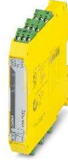
IEC 61508'e göre SIL 3, 2 kumanda devresi, 1 diyagnostik akım kanalı, geniş aralıklı giriş
