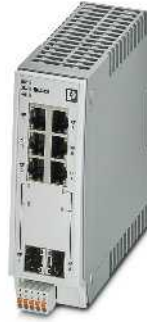
6 RJ45 bağlantı noktası ve 2 SFP bağlantı noktası 10/100 Mbps
