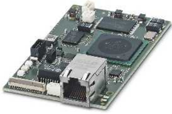
VPN'li tümleşik firewall/router
