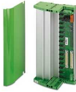
16 PSR-FSP modülü için sonlandırma taşıyıcısı
