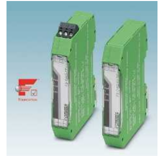
FOUNDATION Fieldbus için saha diyagnostik modülleri
