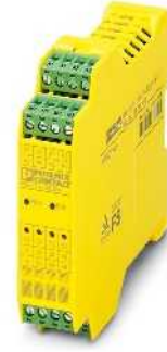
4 güvenli röle çıkışı (1-kanal) veya 2 güvenli röle çıkışı (2-kanal)
