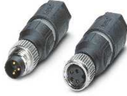
Bağlantı kesit alanı: 0,08 mm 2 ... 0,25 mm 2 , 2 mm pin aralıklı 3 ve 4-pinli
